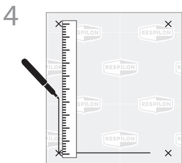
Соедините отметки для того, чтобы сделать контур мембраны для рамы.
