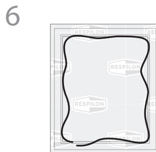
Поместите мембрану RESPILON® на раму и подготовьте уплотнитель (обеспечивающий примыкание).
