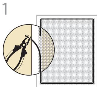
Уберите старый уплотнитель (обеспечивающий примыкание) с рамы.
