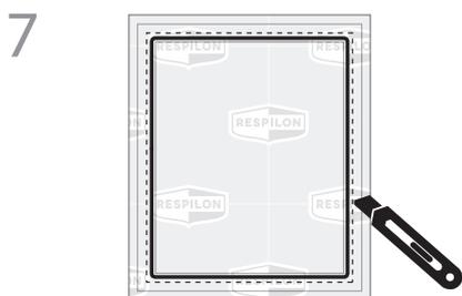
Вставьте мембрану RESPILON® в раму используя уплотнитель и затем отрежьте лишнюю мембрану с помощью канцелярского ножа.
